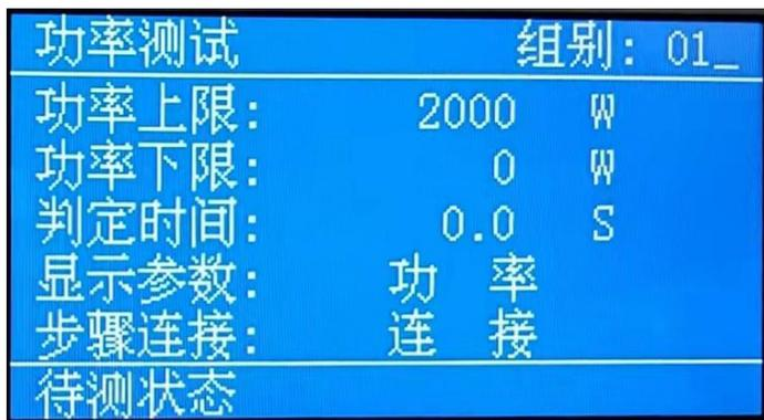
再按设置键进入参数设定模式，∧或∨键作为选择参数项目的操作键。该参数的设定项目依序为：功率上限设定(单位为 1W / step)、功率下限设定(单位为 1W / step)、测试时间设定(单位为 0.1S / step)、显示参数、步骤连接。
