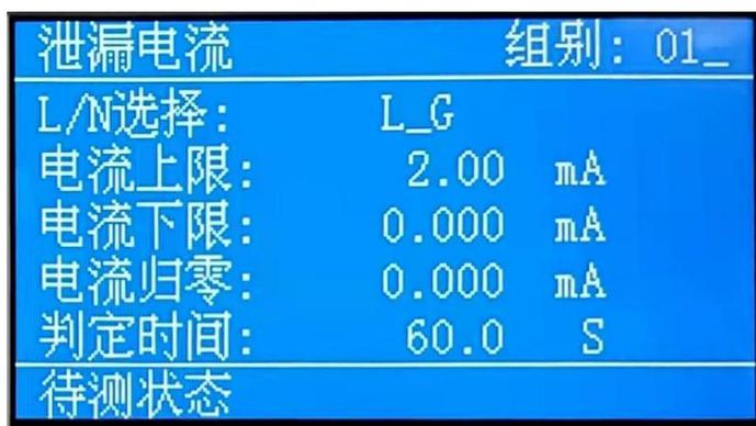
再按设置键进入参数设定模式， $\wedge$ 或 $\vee$ 键作为选择参数项目的操作键。该参数的设定项目依序为：测试棒选择(N\_G 或 L\_G)、电流上限设定(单位为 0.01mA / step)、电流下限设定(单位为 0.001mA / step)、电流归零设定(单位为 0.001mA / step/TEST)、测试时间设定(单位为 0.1S / step)、电源选择、步骤连接。
