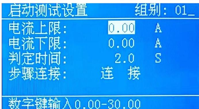
再按设置键进入参数设定模式，∧或∨键作为选择参数项目的操作键。该参数的设定项目依序为：电流上限设定(单位为 0.01A / step)、电流下限设定(单位为 0.01A / step)、测试时间设定(单位为 0.1S / step)、步骤连接。
