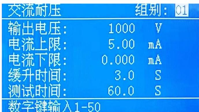
请用数字键输入的测试程序记忆组 1-50，再按确定键，执行程序会读出该测试程序记忆组内所储存的设定参数，并回到待测模式，可依照所读出的测试参数执行测试。在待测状态下可按  $\wedge$  或  $\vee$  键增加或减少测试组别值，并读出相应的设置数据，以供使用。组别数据后的 “\_” 是该组别数据是否连接到下一个组别。
