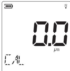
出现显示值0.0  $\mu\text{m}$ ，此时对铁基进行零点校准。
