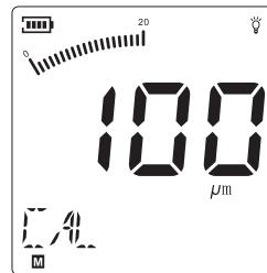
选择厚度在95~105间的标准片，按“▲”和“▼”键修改显示值，使显示值与标准片的标称厚度一致，再将标准片放在铁基上进行校准。
