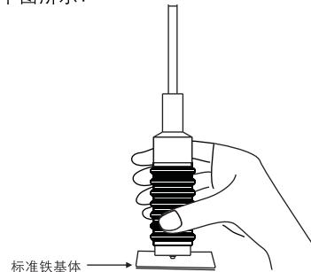
c. 在不提起探头的情况下，按“ $\blacktriangle$ ”和“ $\blacktriangledown$ ”键修正读数后，校准已完成，可以开始测量了。
