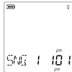
▷ 将探头与测试面垂直接触并轻压探头, 屏幕显示测量值, 如: $109\mu\text{m}$ , 并响一声“嘀”, 此时LCD屏幕显示如下:
