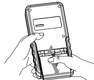
正确的将9V电池放入电池舱内，注意电池的极性，然后合上电池门，如下图：
