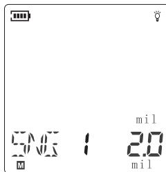
c. 要准确地校准零点，须重复上述a、b以获得基体测量值小于 $1\mu\text{m}$ ,这样有利于提高测量精度。
