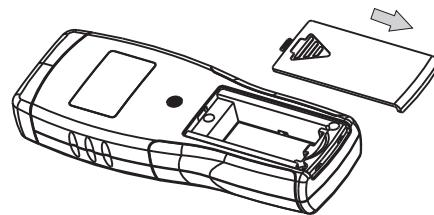
正确的将9V电池装入电池舱内，注意电池的极性，然后盖上电池门，如下图：
