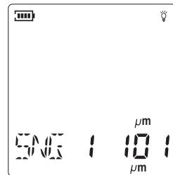
▷ 将探头与测试面垂直接触并轻压探头, 屏幕显示测量值, 如:109μm, 并响一声“嘀”, 此时LCD屏幕显示如下:
