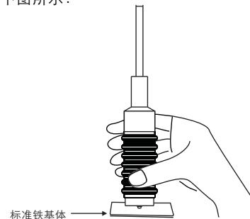
c. 在不提起探头的情况下，按“”和“”键修正读数后，校准已完成，可以开始测量了。此时LCD屏幕显示如下图所示：
