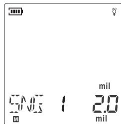
c. 要准确地校准零点，须重复上述a、b以获得基体测量值小于 $1\mu\text{m}$ ,这样有利于提高测量精度。
