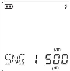
▷ 按“”键即可进行“ $\mu\text{m}$ ”与“mil”之间的单位转换，LCD屏幕如下图所示：
